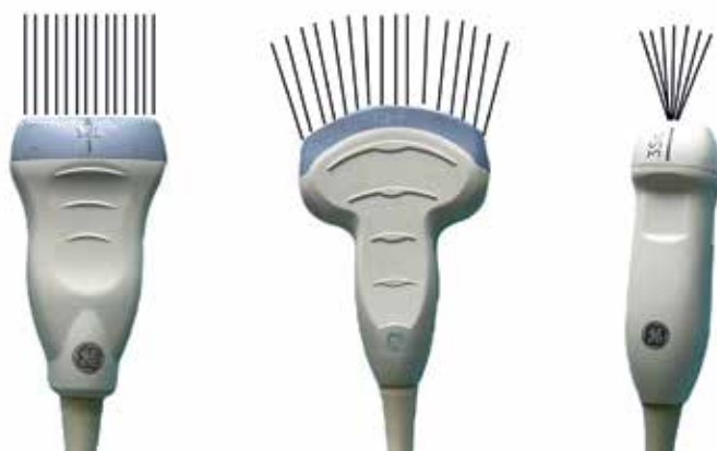
Ryc. 1. Schemat przedstawiający kształt wiązki ultradźwiękowej emitowanej przez poszczególne głowice. Od lewej: głowica liniowa, głowica konweksowa, głowica sektorowa
